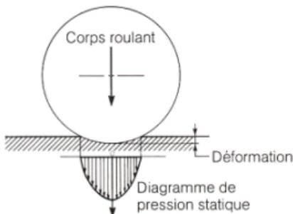
Dans la réalité, les matériaux qui composent les solides possèdent une élasticité (même les matériaux les plus durs) ; cette élasticité amène les solides à se déformer localement, au niveau du contact. La zone de contact devient alors surfacique mais, si les dimensions de cette surface restent petites face aux dimensions des solides en contact, alors elle est assimilée à un point : c'est de la modélisation...
